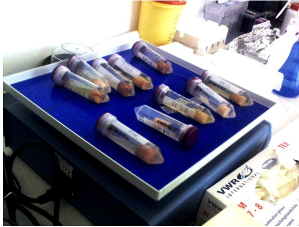
Figura 27. Agitadora utilizada durante o processo de de-fatting dos cilindros de osso trabecular.
