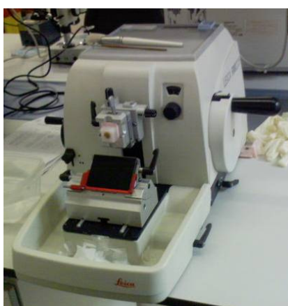
Figura 42. Micrómetro utilizado para obter os cortes com a espessura desejada.
