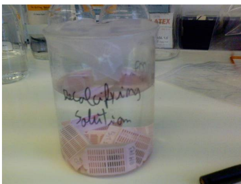
Figura 38. Cassetes com amostras de osso trabecular no interior, submersas na solução descalcificante.
