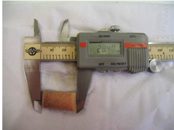
Figura 31. Medição da altura de um cilindro de osso trabecular utilizando um paquímetro digital.
