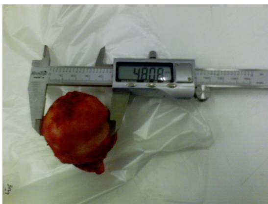
Figura 21. Exemplo da medição do diâmetro de uma cabeça de fémur com um paquímetro digital, segundo um dos planos.
