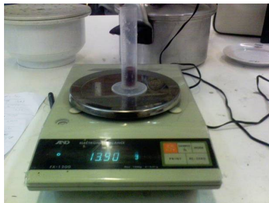
Figura 28. Balança semi-analítica utilizada na medição das massas no cálculo das densidades.
